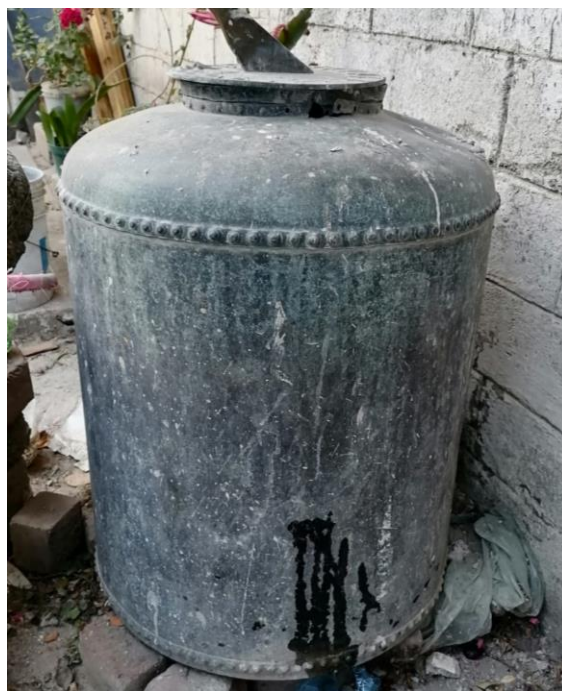
Imagen 7. Alambique con el cual Evaristo Mendieta refinaba la resina que extraía de los árboles de ocote. Foto tomada de donde fue su casa en la calle 5 de mayo, del barrio de Xolalpan. Foto propia. Abril de 2023
